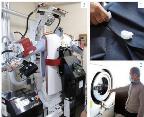
1 作業に入る前に必ず汚れのチェックやボタンカバーをつける 2 16kg用の大型洗濯機で洗いの作業。ドライクリーニングは石油系有機溶剤を使用 3 Yシャツは専用のアイロンにお任せ
